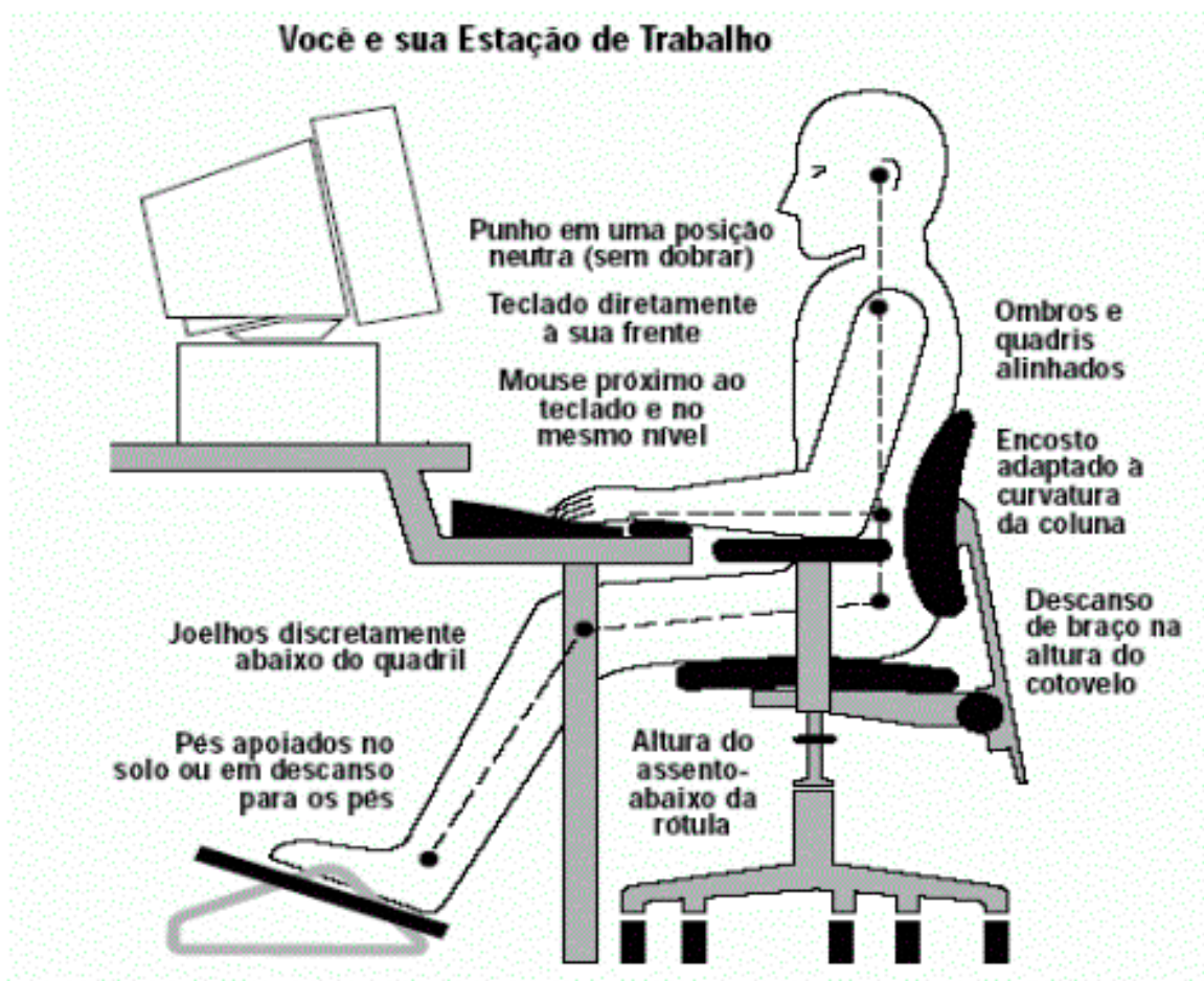
Figura 6 – Posições corretas para trabalho em terminais de computador.
